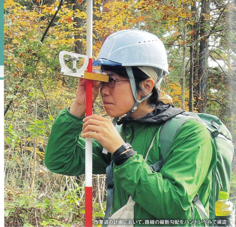
作業道の計画において、路線の縦断勾配を手動レベルで確認
