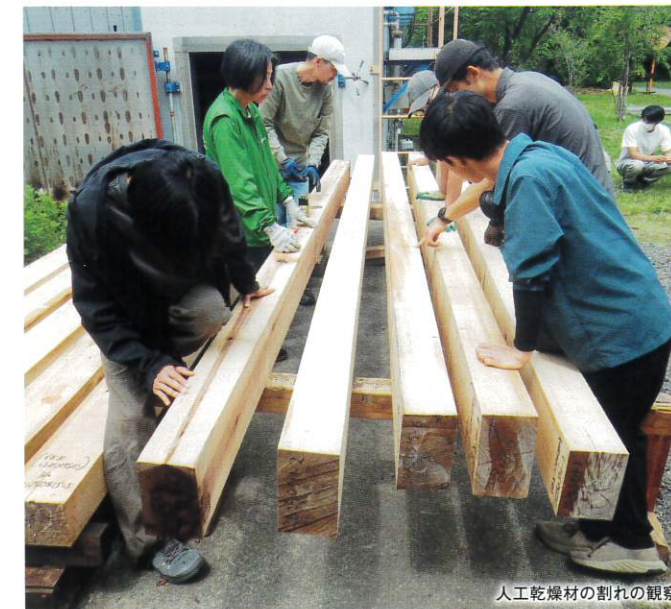
人工乾燥材の割れの観察
