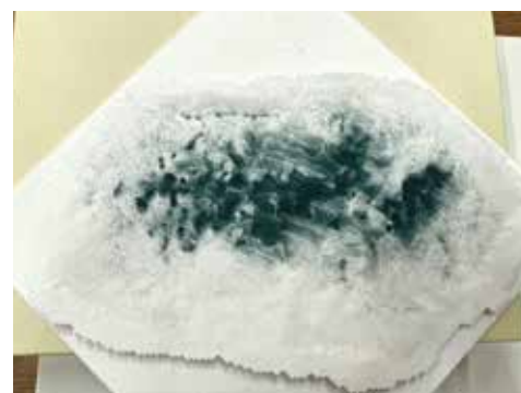
図5 作成した山中峠湿原の地形模型 地形模型に砂をかけると地形の凹凸がよくわかる
