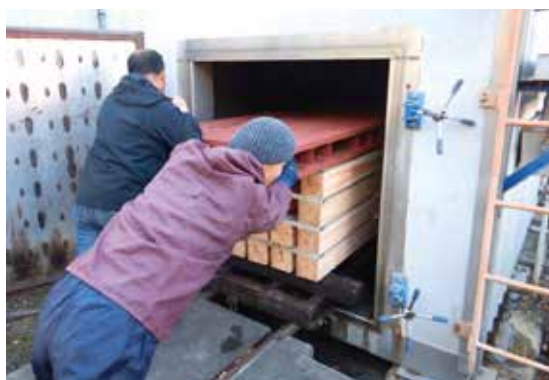
写真1 蒸気式乾燥機による高温セット（窯入れ作業の様子）
