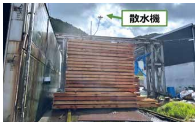
写真4 実務で慣例的に行われている人工乾燥前の散水 （写真提供：東濃ひのき製品流通協同組合）
