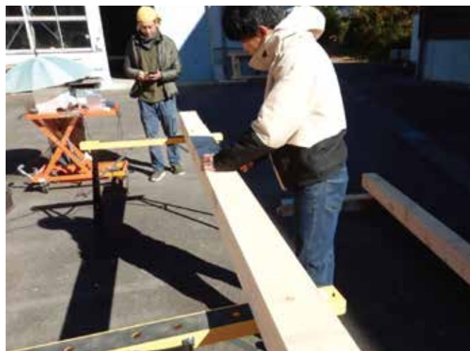
写真2 高温セットを行ったヒノキの「表面割れ」の測定
