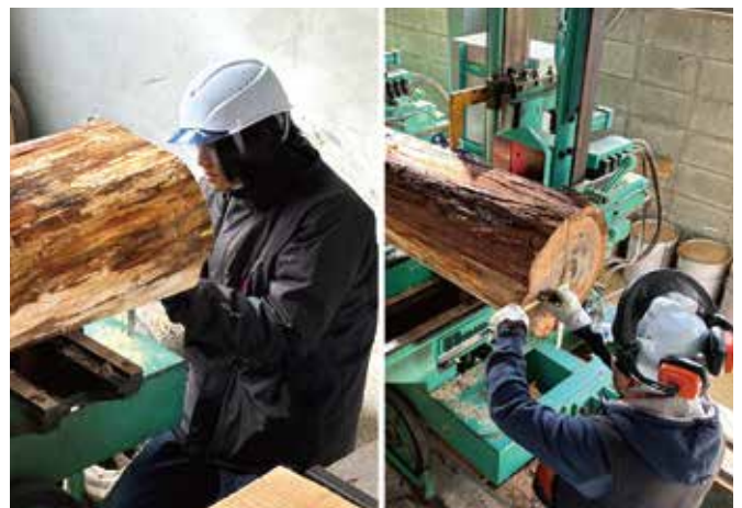
写真4 実習にて「大径材の木取り」を考える（実習「自力建設（製材）」）
