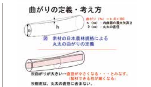
図-1 丸太の曲がりの定義・考え方
