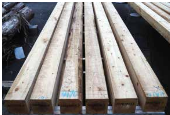
写真2 短時間の高温セットを行ったヒノキ製材
