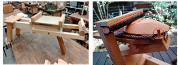
左)器掘りアタッチメントを取り付けた削り馬 右)ゴムクッションと回転防止の棒
