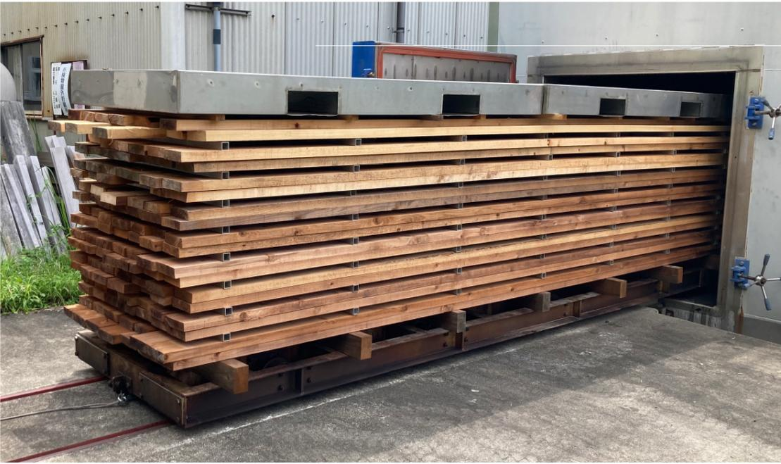
山に生えている木は、水を豊富に含んでいます。スギとヒノキの場合は、木材自体の約15.0%の水分を含んでいます。木材に含まれる水分量を表す指標を「含水率」と言います。一般に「乾燥材」とされる基準は、含水率2.0%以下とされています。15.0%近い状態から2.0%以下まで落として行く工程が、乾燥作業に当たります。
