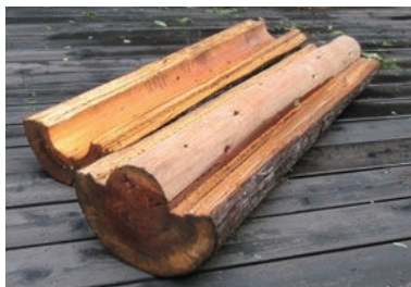
写真-1 目まわりで破断
