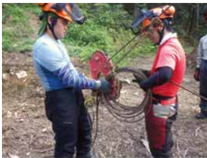
写真-3 クランパーでHBLを固定しHALを搬器に固定
