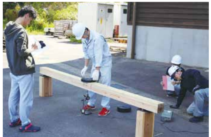
写真-3 曲げヤング係数の測定実習
