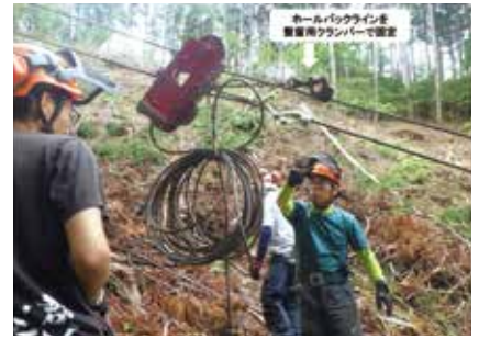
写真-6 搬器のクランパー（上側）でHBLを固定
