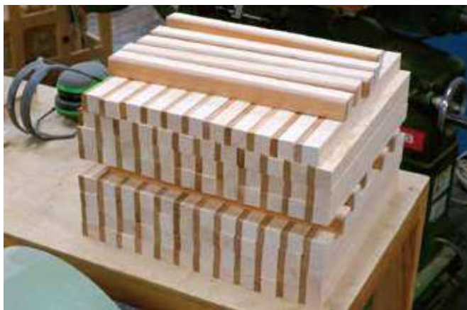
写真-3 サクラとヒノキを接着した木製土台
