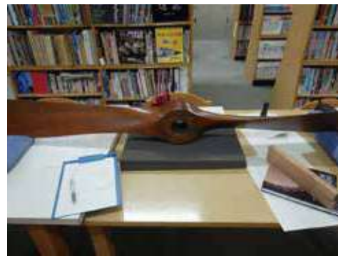
写真-4 オニグルミ材とみられる、甲式四型練習機のプロペラ
