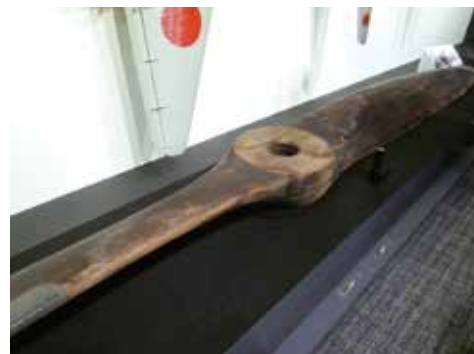
写真-5 マホガニー材とみられる、九二式重爆撃機のプロペラ
