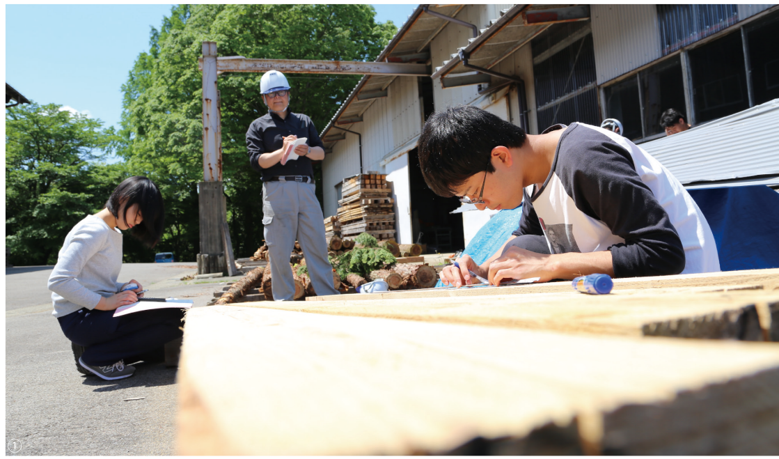
①杉の柱材を天然乾燥させ、表面割れなどの状態を定期的に記録する ②製材機を使った製材。丸太を四角い柱材に加工する
