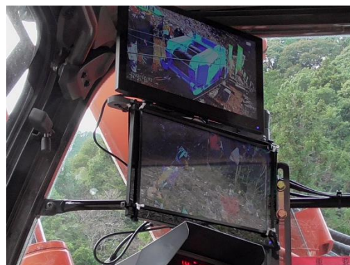
モニター (集材機の作動映像、搬器からの画像)
