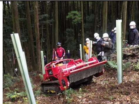
リモコン草刈機の傾斜地における 走行能力試験
