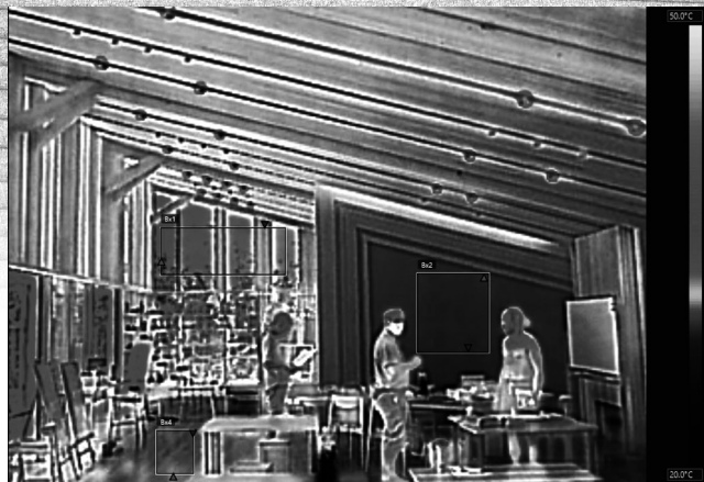
室内のサーモ画像(表面温度は天井35.1℃、西側ガラス窓33.5℃、中央の左官壁29.9℃、床31.5℃)
