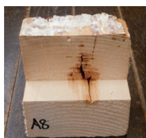
図3 ユニットを取り付けた上面から、腐朽菌が木口(写真奥)へ迂回して材の内部を腐らせた例。
