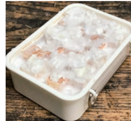
図1 菌糸がまわった腐朽源ユニット。ゼリー状の培地に処理の対象と同じ樹種の小片を並べて腐朽菌を接種し、製作する。
