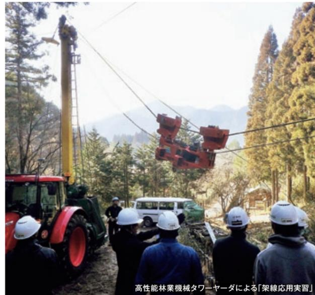
高性能林業機械タワーヤーダによる「架線応用実習」
