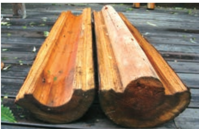
写真-6 目まわり部分のせん断破壊
