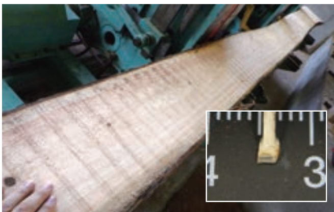
写真-5 歯先の欠損と「挽き肌」
