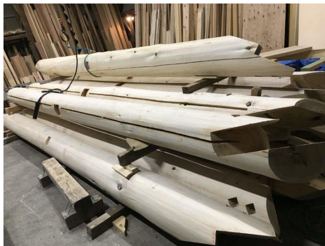
丸太の加工が終わって morinos の現場への出発を待つ V 字柱
