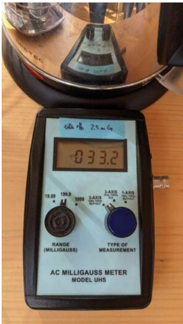
電源を入れると、消費電力が1200Wなので、12Aという大きな電流が流れます。(100V×12A=1200W) 磁場測定器を近づけると、33.2 mGと基準値の13倍近い磁場が発生しています。
