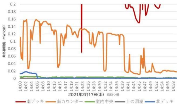
紫外線は木材の変色にも影響します。木材は紫外線によって、時間とともに徐々に黄色化し、心材と辺材の差が均一化し、さらに銀鼠色に変化していきます。この変化の美しさも木材の持ち味です。開口部を閉めてガラスのみにしていると、紫外線が抑えられ、変化がゆるやかに進行します。開口部を開けていると、紫外線が入射、反射し、変化具合がより促進していくと考えられます。
