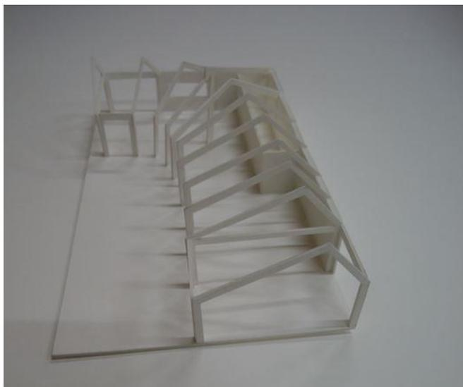
構造は、門型ラーメンフレームを連続させつつ曲げて一体の室内空間を構成。
