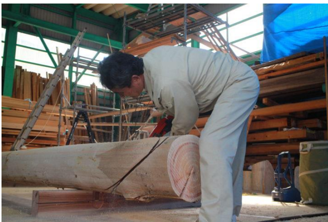
【墨付けに併せて慎重に加工】
