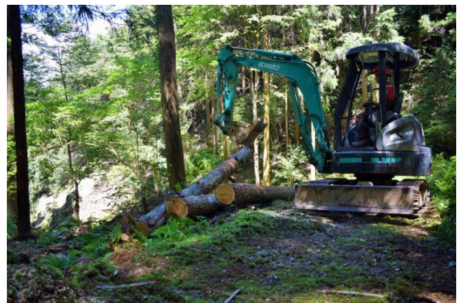
1班は玉切りした単材をバックホウに付けたワイヤで引きずり出し集材しました。
