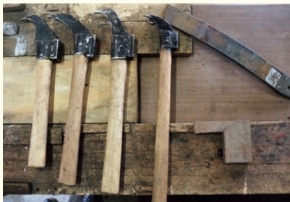
日下部 氏自作の改良コトビ各種と材料の板バネ
