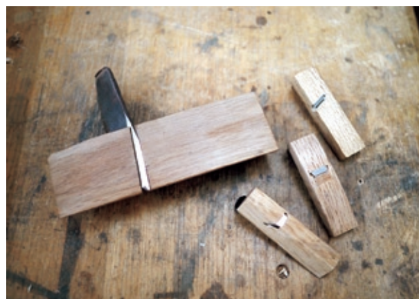
玉田 氏が SETSUNA 製作のために自作した鉋
