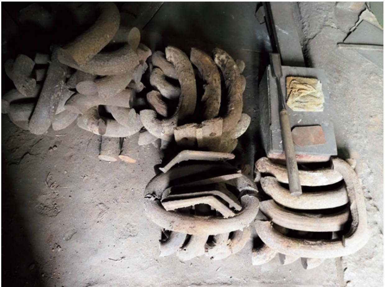
錬鉄の材料として、新潟県は鉄橋やレール、三木市はアンカーチェーンがよく用いられるという傾向がある。 写真はアンカーチェーン。
