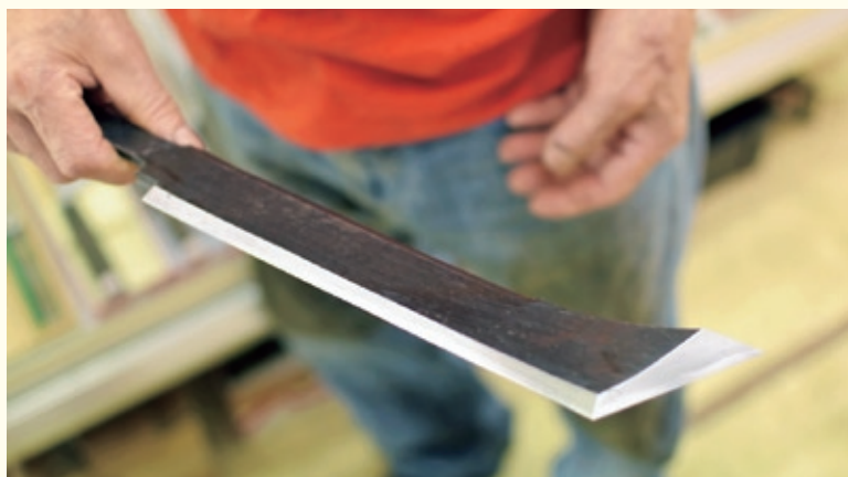
檜皮包丁(ひわだぼうちょう) 日本古来の屋根工法である「檜皮葺(ひわだぶき)」に用いられる ヒノキ樹皮を成形加工するために用いられる専門の刃物
