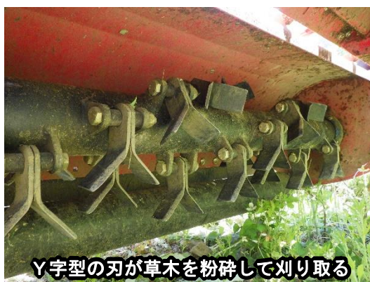
使用したラジコン草刈り機
