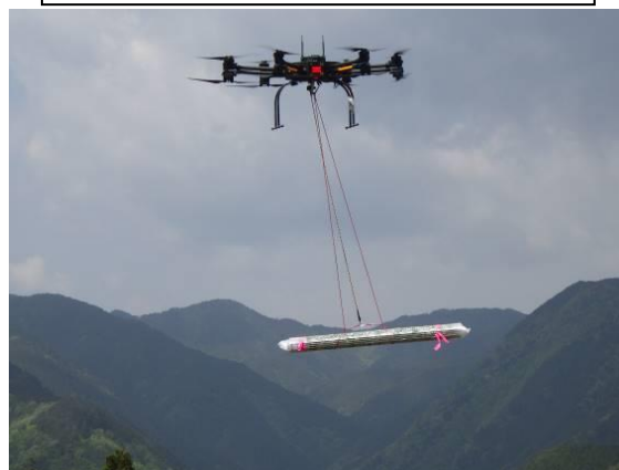
「KATANA」による運搬状況(支柱)
