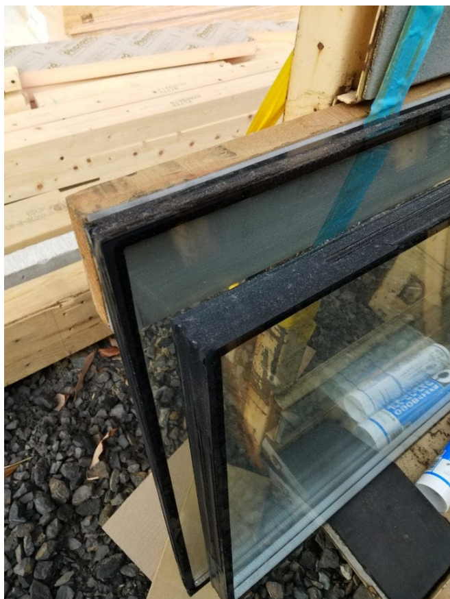
複層ガラスの断面:手前がトリプルガラス、奥がペアガラス
