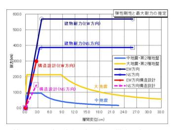
剛性について、東西方向も南北方向も構造設計における 剛性よりも常時微動測定による推定剛性が高いです。 これは、木材の材料品質・乾燥・施工精度のばらつきなど を構造設計時に考慮するために「構造架構」の剛性(実質 的には強度)を安全側に低減して設計したため、構造設計 で算入していない土塗り壁の剛性の影響などであると考 えられます。すなわち、①設計での想定以上に「構造架構」 の施工精度が良く、②当該建物には実質的な剛性・耐力が 設計値以上にある、などが考えられます。
