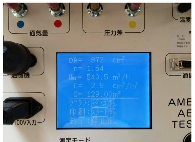
総相当隙間面積 αA は  $372 \text{ c m}^3$ 。相当隙間面積 C 値は  $2.9 \text{ c m}^3/\text{m}^2$  となっています。
