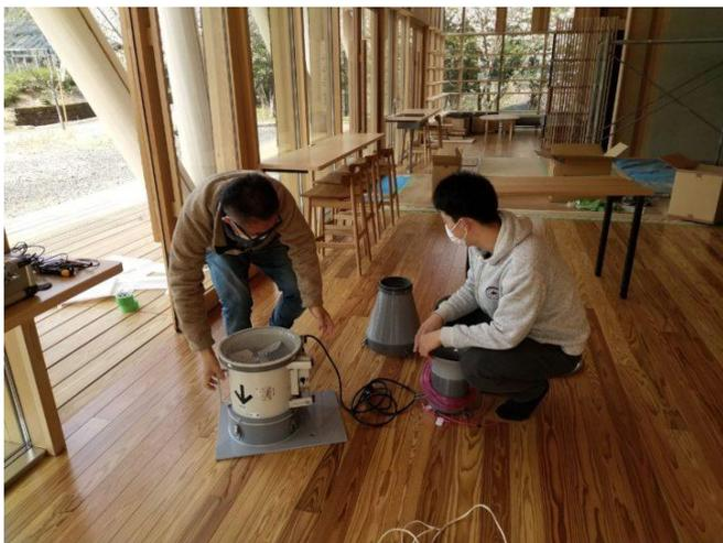
この組み立てあがった気密測定機を開口部にセットして廻りをプラダンボードで塞いで目張りをします。
