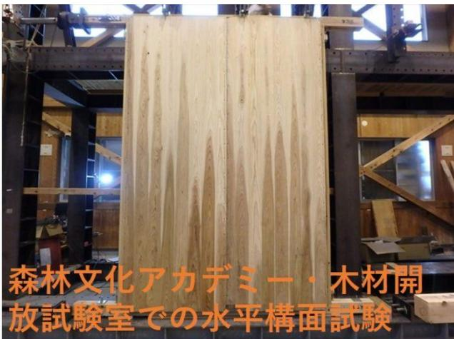
また、この建物では CLT パネルを軸組に耐力壁用の面材として利用しておりませんが、A パネによる CLT 面材耐
