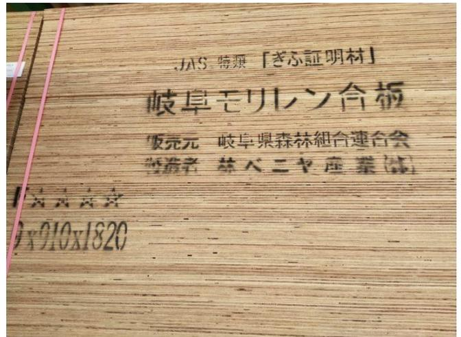
合板とは、木材をカツラ剥きした単板(ベニア)を奇数枚直ちに積層したもの。よく合板のことをベニアと間違われますが、ベニアは薄い板1枚のことで、このベニアを積層したものが合板となります。最も古くから使われている木質材料で、合板の中でも強度特性に関する品質管理・評価・保証が厳しく、基準強度も与えられたものが構造用合板です。単なる合板とは、接着剤が大きく異なります。
