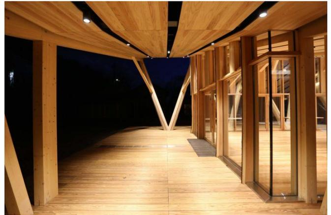
室内は各種プログラムに合わせられるように、②視認性、④演出の付与を確保しやすい可変式として、照明のほとんどが調光機能付き、さらに照明ダクトで光源の移動や追加もできます。落ち着いた安らげる空間を目指し、色温度は低めの電球色として、③快適性にも配慮しています。全灯するとかなり明るいですが、使用するときはいまぐれコントロールしてくださいね。
