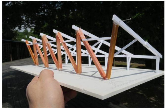
概ね模型で実現可能性、高さ、構造材の間隔、形態などを検討し終わると、具体的な力の流れを検証するために構造解析に入ります。
