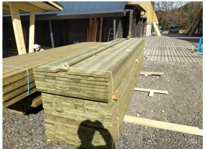
時間経過とともに、次第に茶色、グレーと変化していきますが、先ほどの表層圧縮スギ材と並べて張ると違和感が出てきます。そこで、アカデミー本校舎でも使用している自然系塗料の一つドイツ製のオスモカラーを調合して色合わせを行いました。
