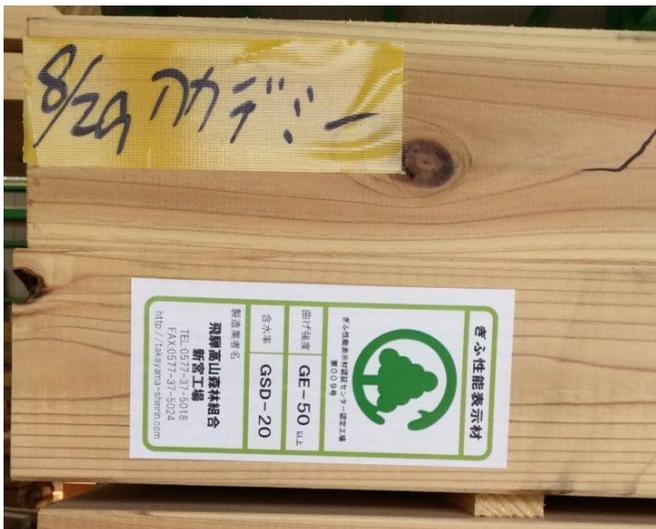
そのうえで工務店さんの方でも、グレーディング(曲げ強度を計測)もかけて品質管理をしています。さらに、私たちも含水率計で、品質の確かさを確認しました。
