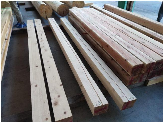
当然、使用するのは、「ぎふ性能表示材」。ぎふ証明材の産地認証に加え、構造設計に必須の曲げ強度と含水率も計測され表示された材です。
