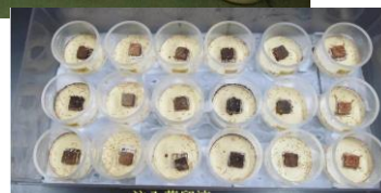
▲防腐(上)・防蟻(下)の試験の様子
